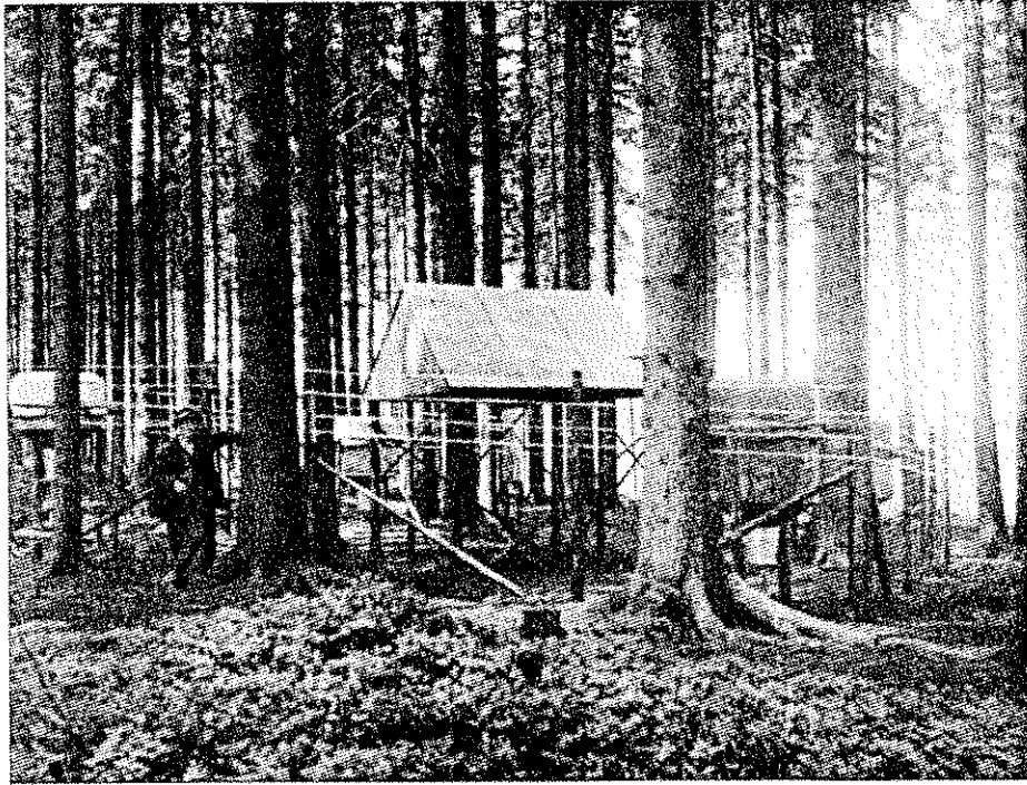
Abb. 5. Nebelmeßgerät (Nm 2) im Fichtenalldholz zwischen 4 großen Regenmessern. (Rm 7-10.)
